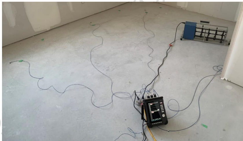
รูปที่ AD14 P11 ตัวอย่างรูปถ่ายสถานที่ระหว่างทำการทดสอบ ที่มา: https://acoustical-consultants.com/built-environment/noise-investigations/how-to-measure-astc-ratings-of-specific-sound-transmission-paths/
