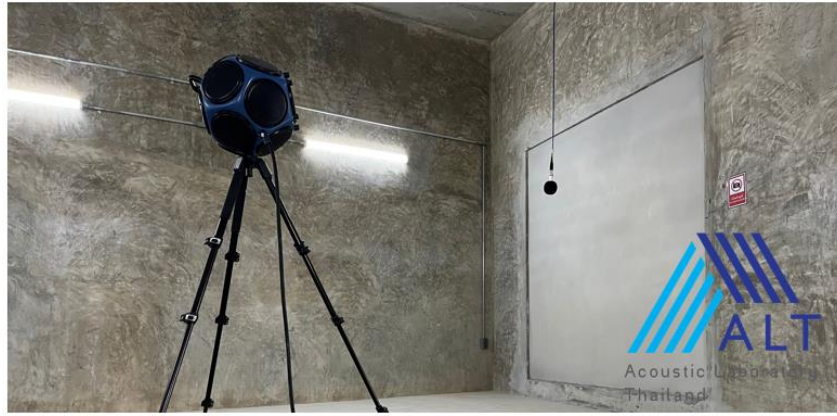
รูปที่ AD14 P5 ตัวอย่างรูปถ่ายสถานที่ระหว่างทำการทดสอบค่า STC
